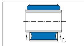
Fig. 2 Radial load
