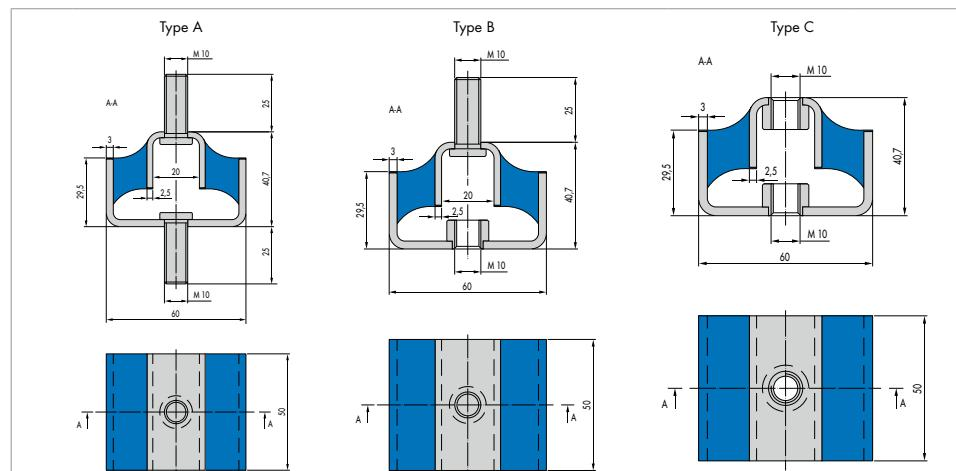
Fig. 4 Double U-Shear Mount 053 18 702, , 053 18 703 and 053 18 704
