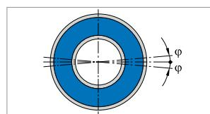
Fig. 5 Torsional load
